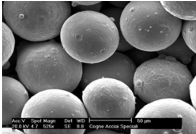
La polvere COGNE è atomizzata e raffreddata in atmosfera inerte di azoto. Questo processo permette a COGNE di produrre particelle sferiche con una composizione chimica uniforme e con un basso tenore di ossigeno. La polvere è vagliata utilizzando vagli ad ultrasuoni in modo da ottenere una distribuzione granulometrica precisa e adatta a tutte le applicazioni
